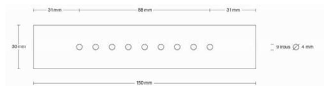
Trous centrés en hauteur et en largeur : 11 mm entre chaque axe de perçage
